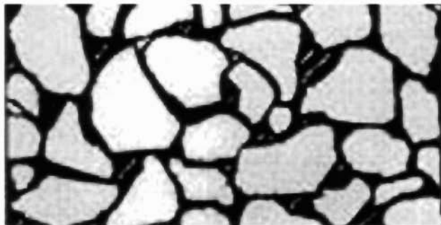
Рисунок 2. Каркасно-щелевая структура щебеночно-мастичного асфальтобетона
