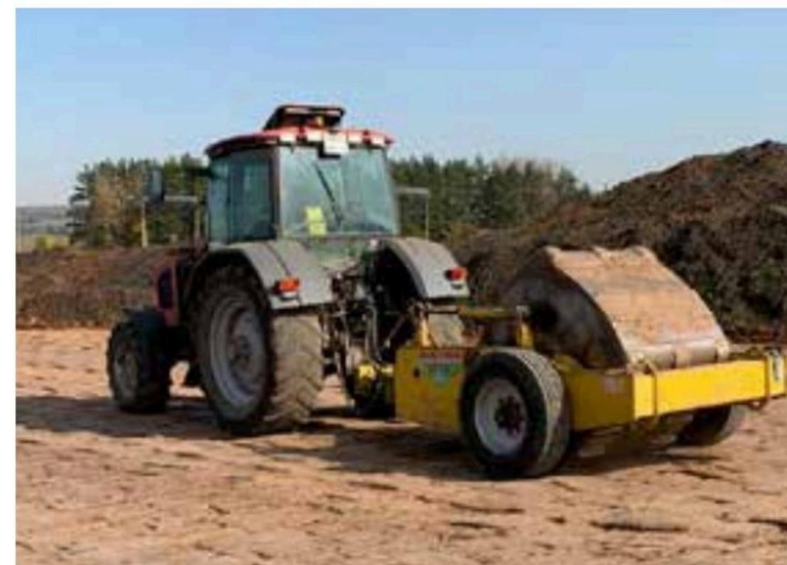
справляющаяся с поставленными задачами. Но при всех своих достоинствах, такие уплотняющие машины могут эффективно прорабатывать грунты толщиной около 30 см. при рабочей скорости перемещения не выше 6 – 8 км/ч, что сказывается на сравнительно невысокой сменной выработке. И с целью ускорения темпов строительства необходимо задействовать парк машин.
