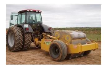
Как показала мировая практика, наиболее эффективным и экономически целесообразным методом разрушения цементобетонной плиты является метод ударнодинамического фрагментирования с помощью прицепного ударного бетонолома ИМПАКТОР-3000. Ступая в ногу со временем и являясь официальными дилерами американской компании-производителя «IRT», группа компаний «Растом» первой завезла в Россию и начала строительные работы с применением ударного бетонолома ИМПАКТОР-3000.
