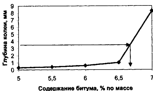
Рис. 14. Влияние содержания битума на расчетную глубину колеи в покрытии из ЩМА
