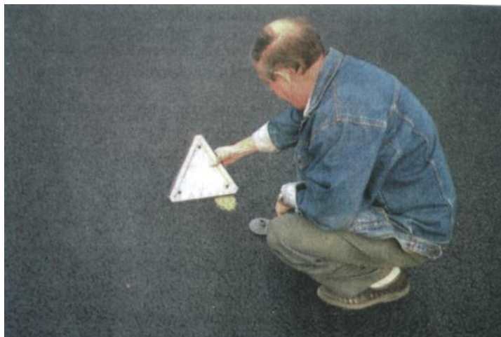
Рис. 34. Измерение шероховатости ЩМА методом «песчаное пятно»
