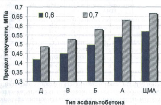
Рис. 39. Предел текучести асфальтобетонов различных типов при нормальном давлении 0,6 и 0,7 МПа
