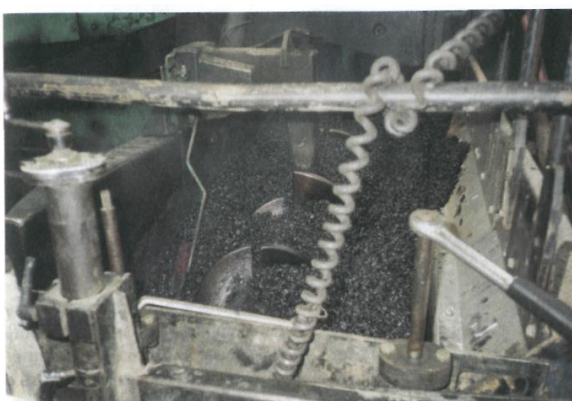
Рис. 23. Распределение смеси в шнековой камере асфальтоукладчика
