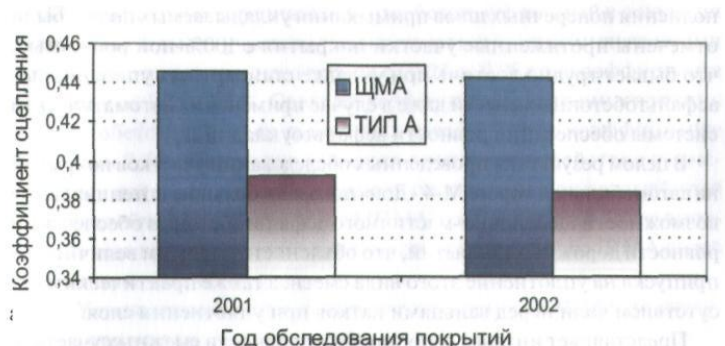
Рис. 71. Сравнение фрикционных свойств покрытий из ЩМА и типа А в различные годы обследования
