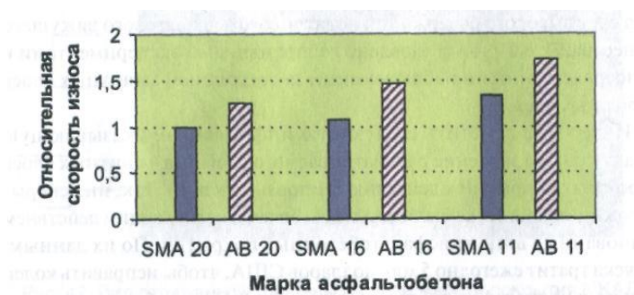
Рис. 43. Влияние марки асфальтобетона на скорость износа покрытия
