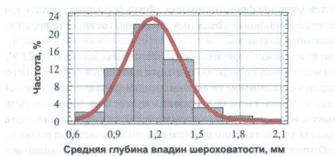
Рис. 49. Статистическое распределение глубины впадин шероховатости в покрытии ЩМА-15
